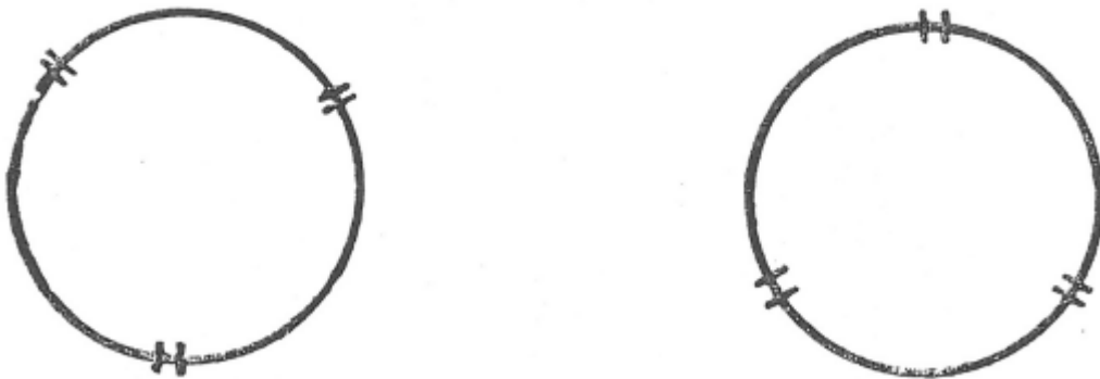
1.4. ábra 3 db acélívből épített szerkezet
