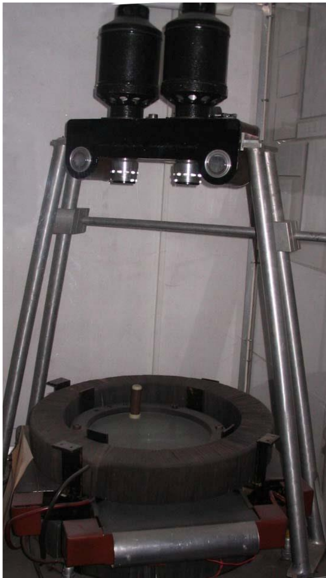
Ezt az expanziós ködkamrát használta Szalay Sándor és Csikai Gyula a neutrínó kimutatására
