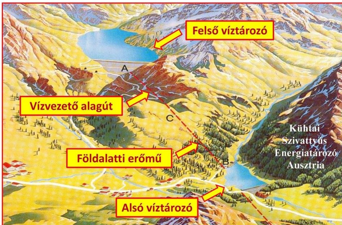
2.26. ábra: Tározós- és nyomólagútas erőmű elrendezése
