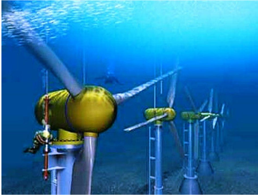
2.34. ábra: Áramlaterómű elvi felépítése
