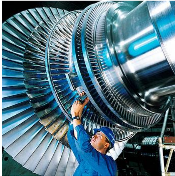
2.5. ábra: Gőzturbina lapátsorai
