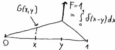
$G(x, y)$ : Az  $y$  pontban ható egységnyi erő mekkora kitérést (választ) hoz létre az  $x$  pontban
