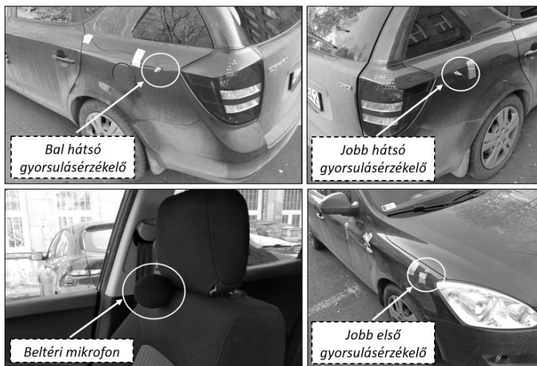
8.3.1 ábra. Rezgés gyorsulás érzékelők elhelyezkedése a gépjármű karosszériáján és a mikrofon az utastérben
