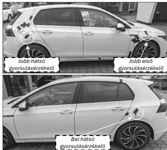
8.7.1. ábra A személygépjármű karosszériáján definiált mérési pontokban elhelyezett szenzorok
