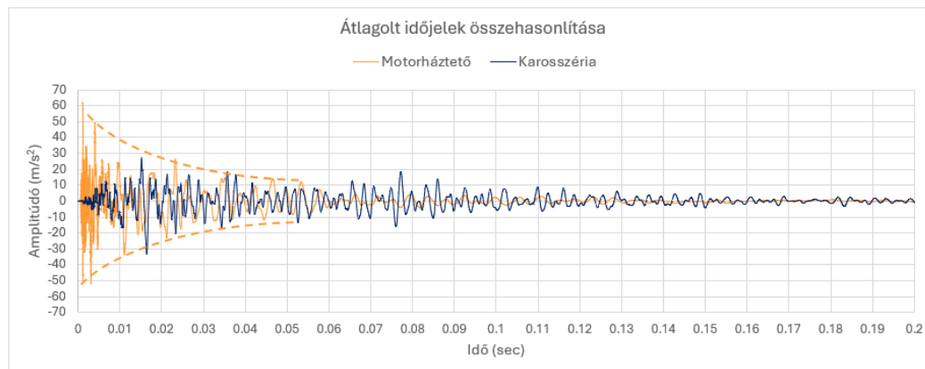
9.3.7 ábra. A motorháztető és karosszéria vizsgálat során felvett átlagolt időjelek összehasonlítása
