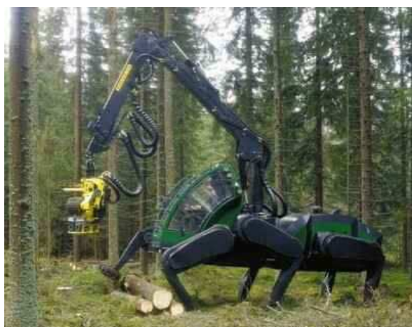
8.2. ábra Lépegető erdőgazdasági gép és formai megfelelője: a zsiráfnyakú levélsodró
