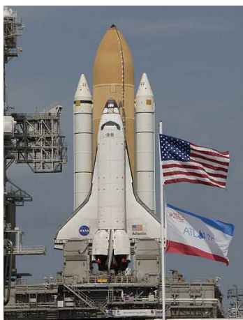
6.4. ábra. Az űrrepülőgép két szilárd hajtóanyagú gyorsító rakétáját újra használják
