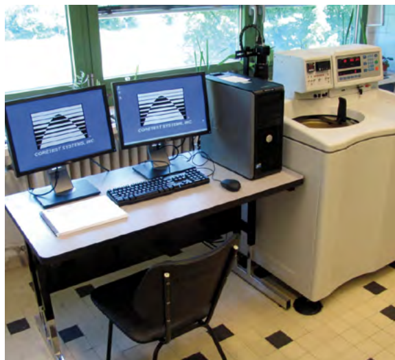
Közet centrifuga adatgyűjtő és feldolgozó rendszere (szállító: Spektrum-3D Kft.)
