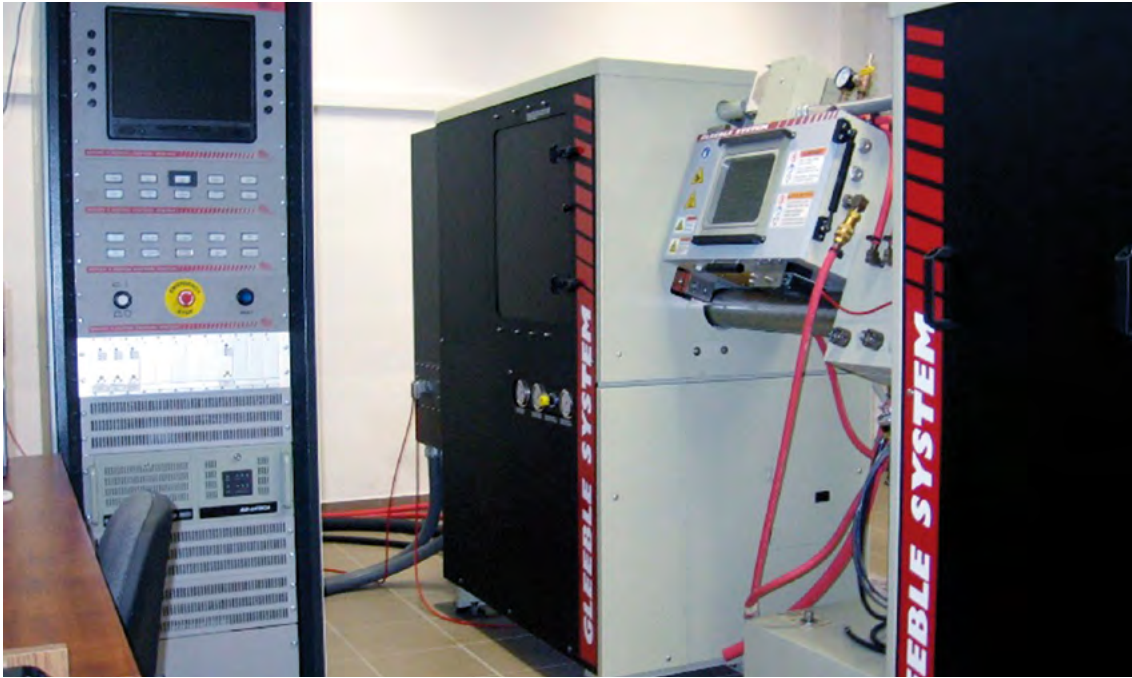
A projektben beszerzett legnagyobb értékű eszköz: Gleeble 3500 termo-mechanikus fizikai szimulátor (szállító: Dynamic Systems Inc., USA)
