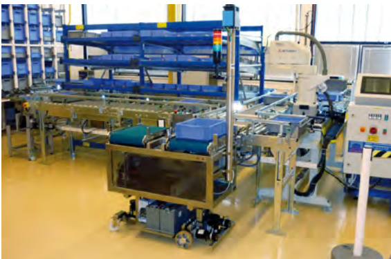
Vezető nélküli targonca (szállító: Gamma Digital Fejlesztő és Szolgáltató Kft.)
