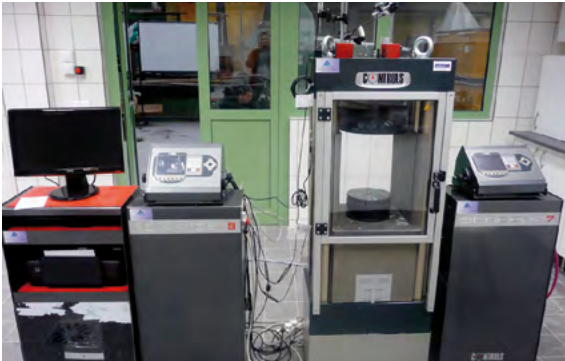
Törőgép követvizsgálatokhoz közdarabokkal, triaxiális kiegészítővel és a triaxiális vizsgálatokhoz olajszivattyúval (szállító: Complexlab Kft.)
