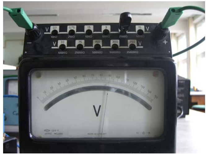
2. kép Adott méréshatárra beállított feszültségmérő
