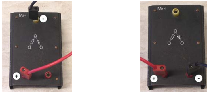
3. kép A karakterisztikák méréséhez így kell bekötni a kétpólust. Bal oldali kép – ellenállás, jobb oldali – dióda és ellenállás.
