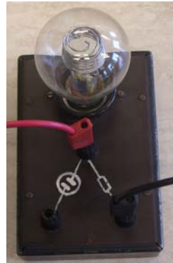
3. kép Az ellenállás karakterisztikájának méréséhez így kell bekötni a kétpólust
