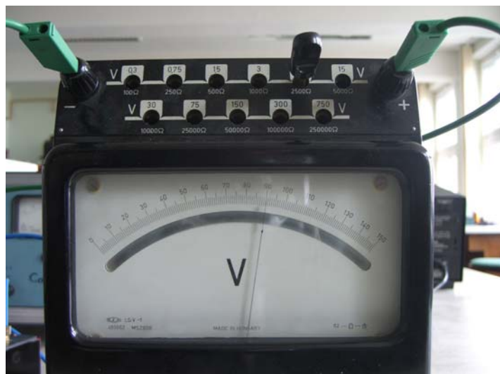
2. kép Adott méréshatárra beállított feszültségmérő
