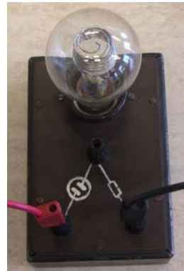
4. kép A közös karakterisztika méréséhez így kell bekötni a kétpólust
