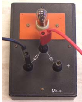
3. kép Az ellenállás karakterisztikájának méréséhez így kell bekötni a kétpólust
