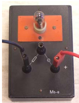
4. kép A közös karakterisztika méréséhez így kell bekötni a kétpólust
