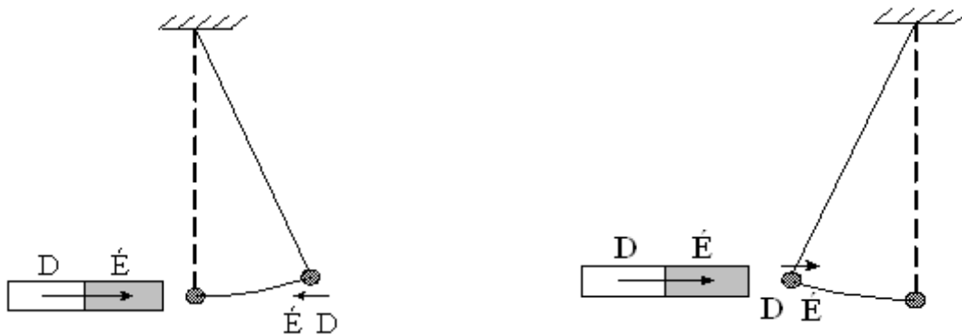
Rúd mágnes és diamágneses, ill. paramágneses anyag kölcsönhatása
