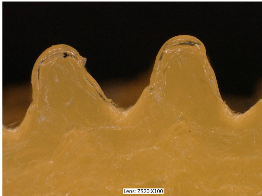
13. ábra: Az FDM-TPLA fogaskerék fogának mikroszkópikus képe z=30 esetén
