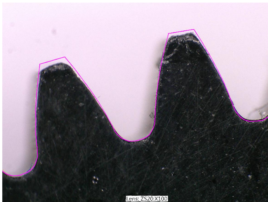
20. ábra: Az SLA fogaskerék profiljának összehasonlítása a kiindulási geometriával z=50 esetén
