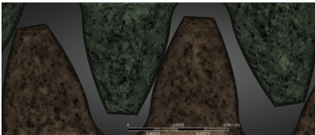
70. ábra: A szimulációkhoz használt 4 μm-es háló
