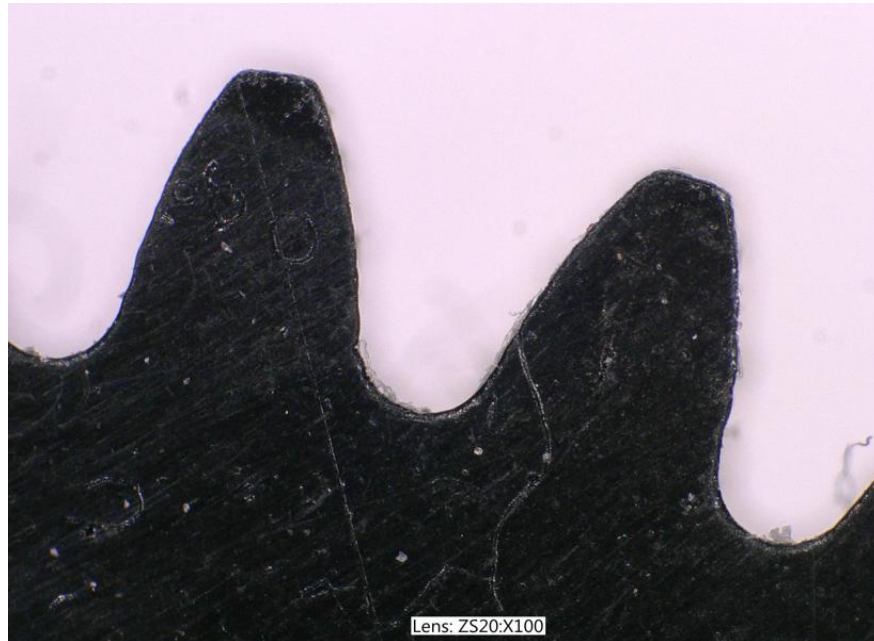
17. ábra: Az SLA nyomtatott fogaskerék fogának mikroszkópikus képe z=30 esetén
