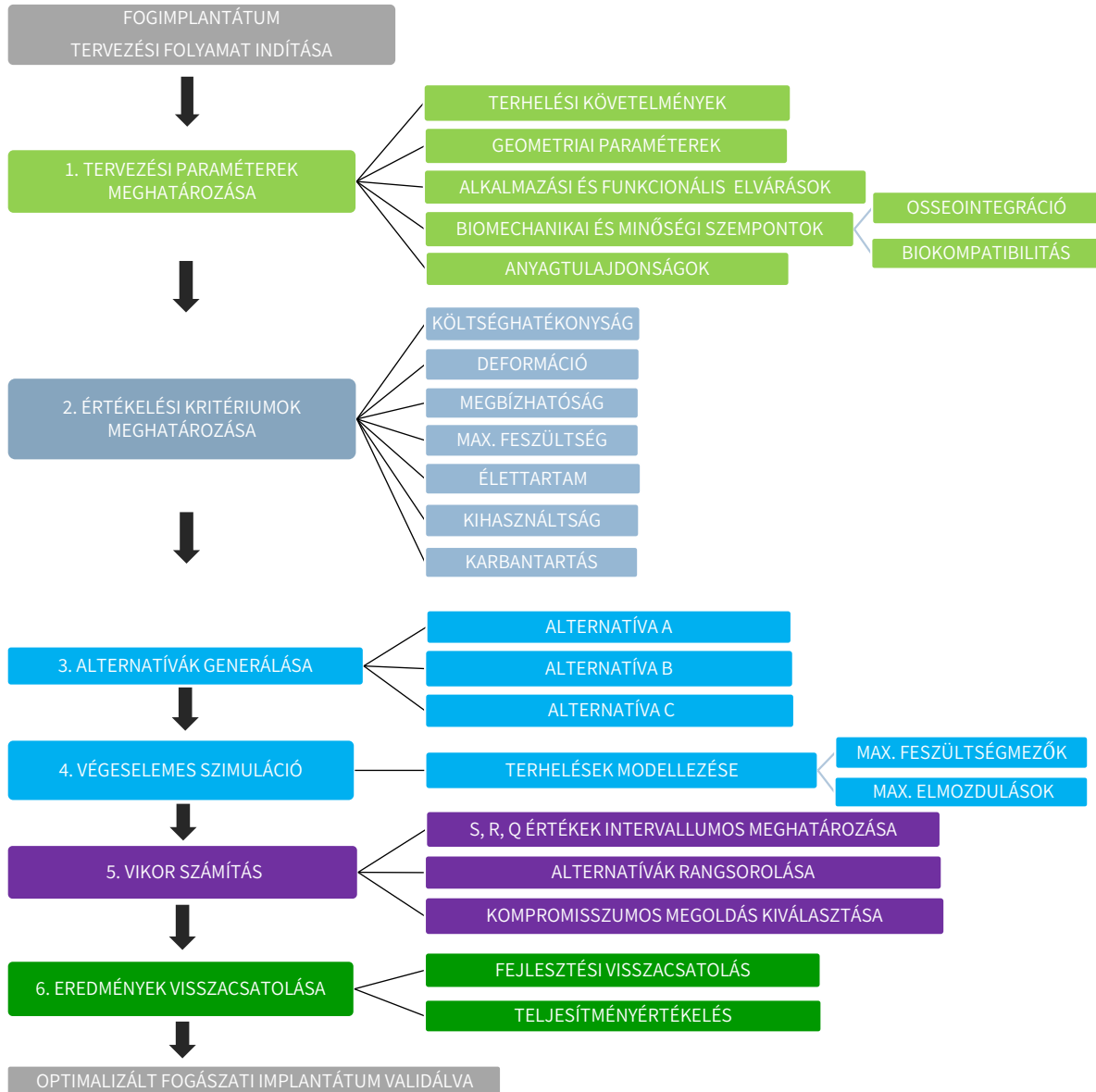
21. ábra Az fogászati implantátum optimalizálása és értékelése során alkalmazott koncepcionális tervezés fázisai: integrált alváztervezési és döntéstámogatási modell
