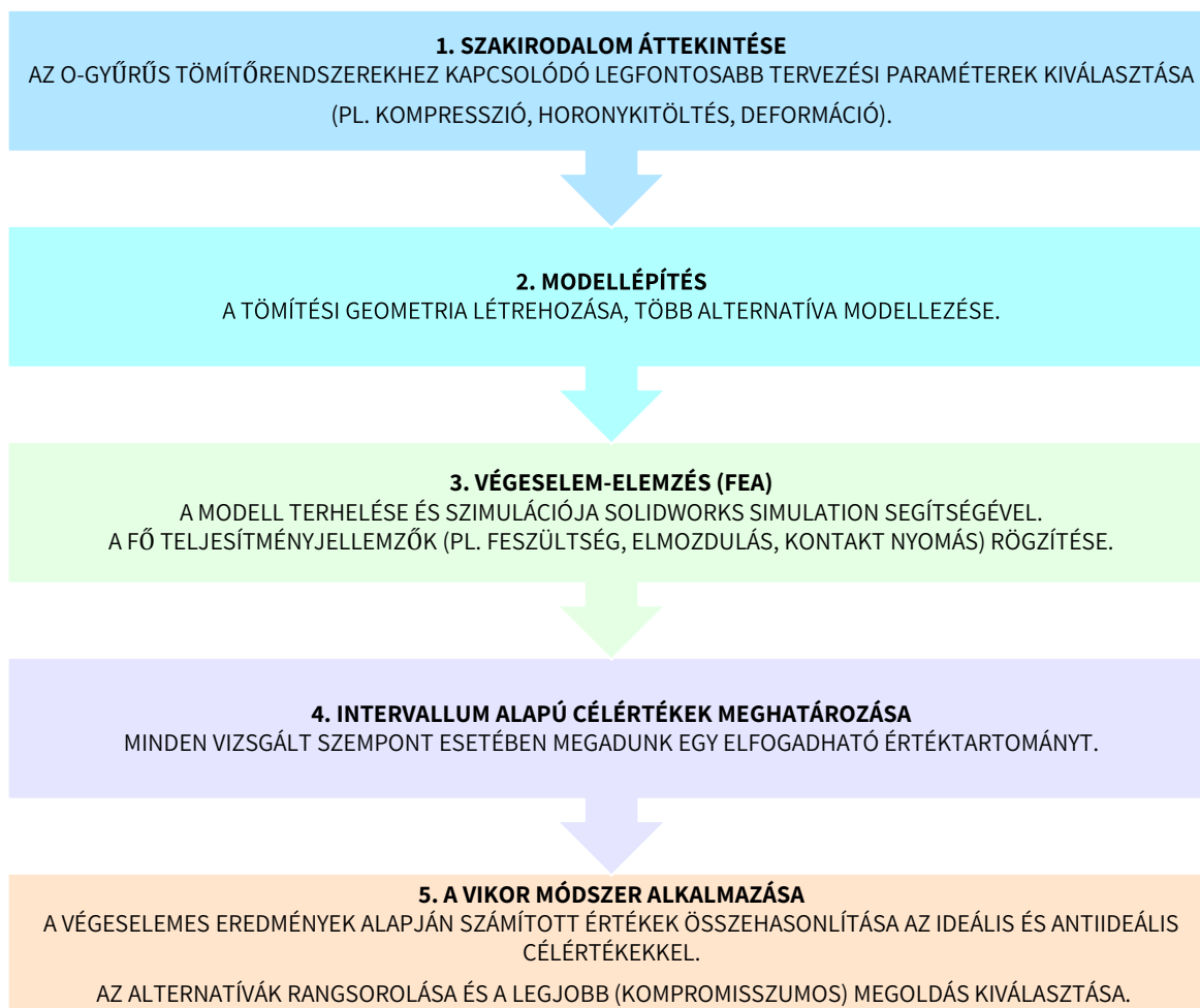
45. ábra A VIKOR-alapú döntéstámogató eljárás folyamata az O-tömítőgyűrűs tömítések optimalizálásához
