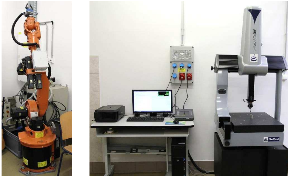
24. ábra A KUKA KR15/2 robot és a TESA MICRO-HITE 3D mérőgép
