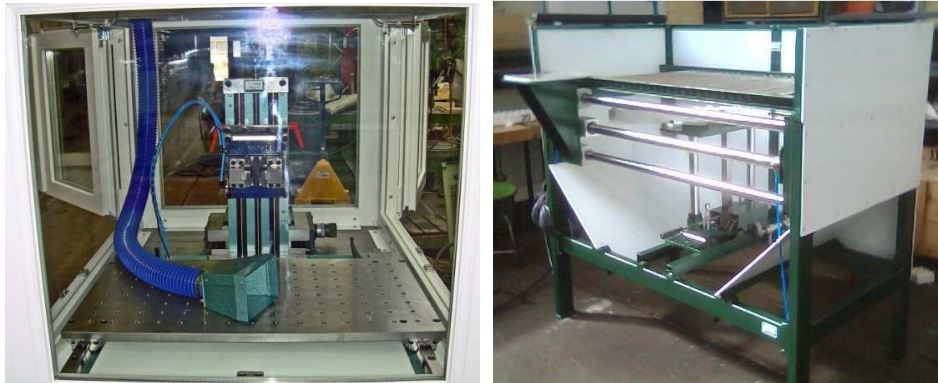
38. ábra Tesztberendezések elektromos kéziszerszámok ellenőrzéséhez
