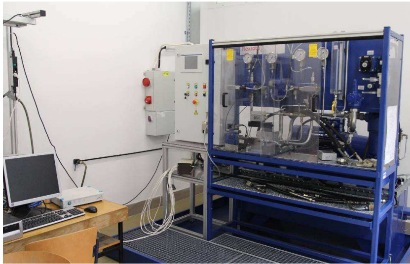
26. ábra Arányos és szervoszelep-vizsgáló munkahely
