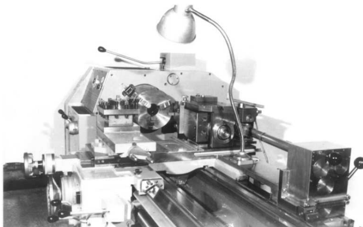
27. ábra Kiegyensúlyozott, késmozgatású sokszögeszterga
