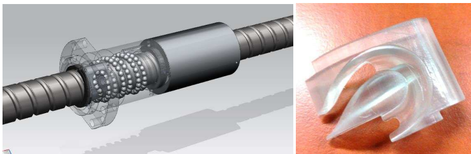
44. ábra Nagy menetemelkedésű golyósorsó és optimalizált VV-tagja
