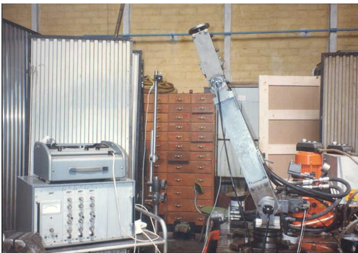
Csuklós manipulátor ismétlési pontosságának mérése (Kép: Németh Róbert GTE-díjas diplomatervéből, 1993)
