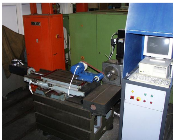
A megépített 2D-s CNC beszúró szalagköszörűgép
