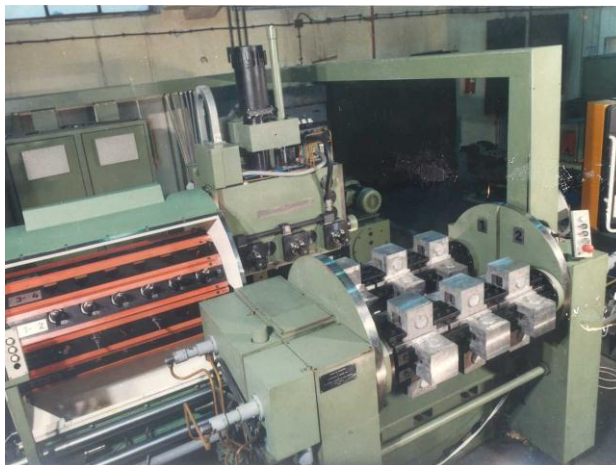
MC 403 háromorsós megmunkáló központ hasábpalletta rendszere (2 hasábpalletta, 12-12 munkadarab)
